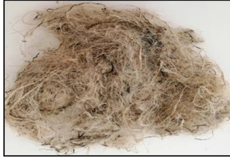
Resim 6. İkinci tarama uygulanan ısrırgan elyaf demeti (Bekiroğlu, 2019)
