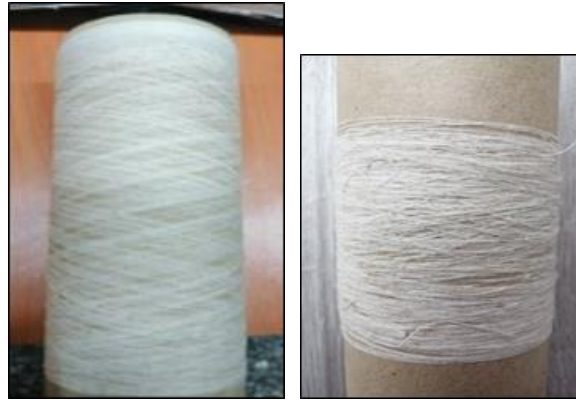
Resim 13. Open-end (%70 pamuk % 30 ısırgan) iplik (Ege Üni. Tekstil Müh. İplik Arge Lab. Bekiroğlu, 2019)
