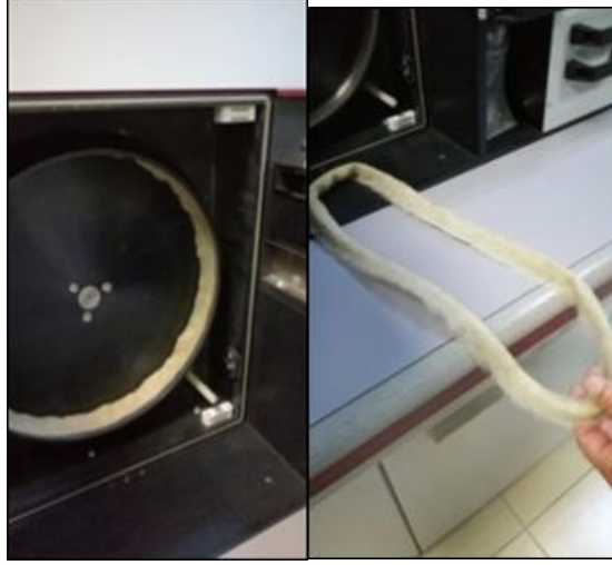
Resim 10. Open-end makinesinde iplik elde etme aşamaları I (Ege Üni. Tekstil Müh. İplik Arge Lab. Bekiroğlu, 2019)
