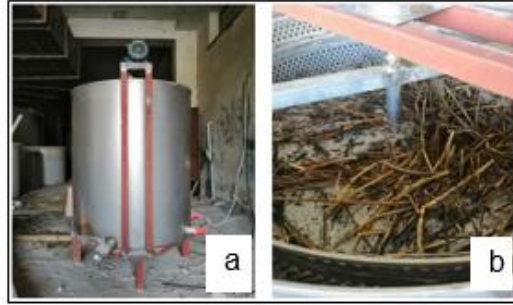
Resim 1. Suda çürütme işlemi uygulanan kazan (a), ısırgan sapları (b) (Bekiroğlu, 2019)
