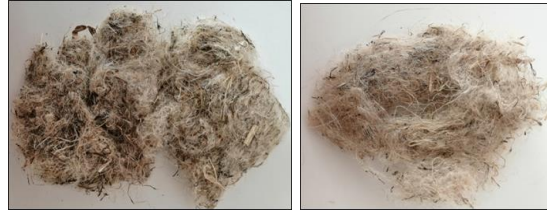
Resim 7. Telefe ayrılan ısrırgan elyaf demetleri, tarak altı ve şapka (Bekiroğlu, 2019)
