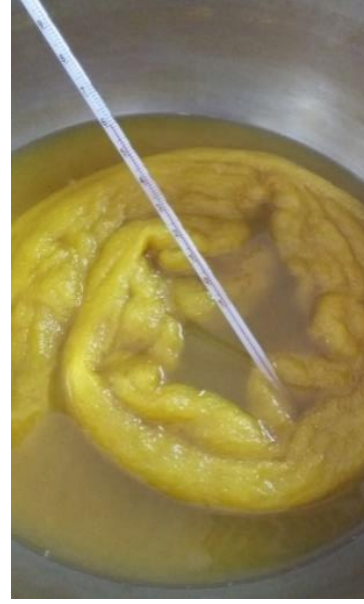
Resim 11. Zerdeçal Ekstraktında Yün Lifinin Boyanması (Kocatürk, 2019)
