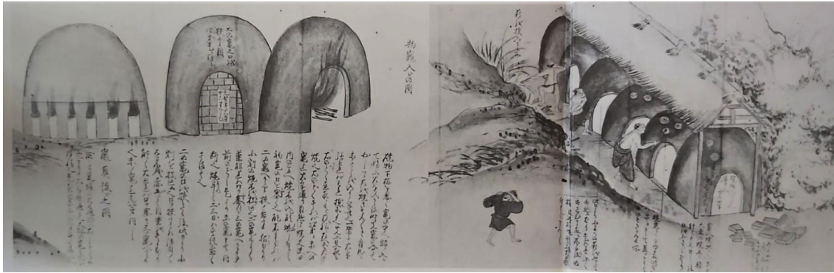
Resim 11. Karatsu Anagama Fırının İllustrasyonu
