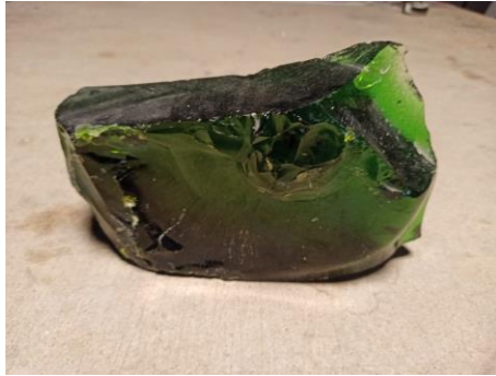
Resim 12. Yalaktan çıkmış frit örneği.
