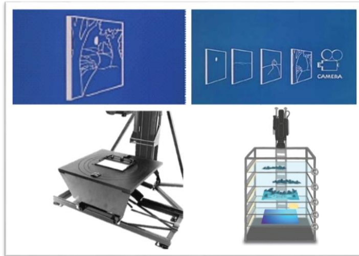
Resim 9. Animasyon Standı (Animation Stand) ve Çok Katmanlı Kamera Sistemi (Multiplaner Camera)
