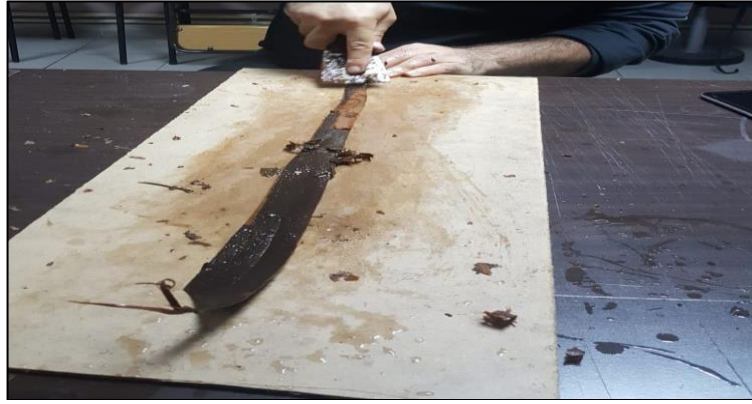
Resim 2. Fındık ağacı kabuklarının liflerinin ayrılması
