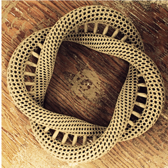
Görsel 4. 3B SLS yazıcı ile Medalta etkinliğinde basılan form ( http://www.editingluke.net/2013/05/3d-ceramic-printer-at-medalta.html )
